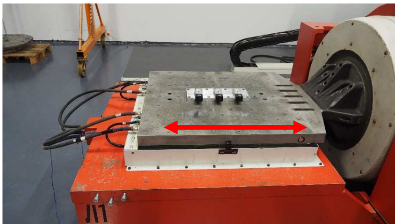
Abb. 3: Prüflinge während der Schwingungs- und Schockprüfungen in zweiter horizontaler Richtung
