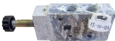
Aluminium- eloxiert nach 720 Stunden
