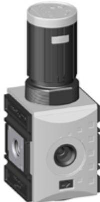
**WICHTIG!** Die Druckregelung in der Pneumatik ist eigentlich eine **Mengenregelung**. Die **Luftmenge im Bereich hinter dem Regler muss so groß sein, dass der eingestellte Überdruck erreicht wird**. Es muss sich ein Gleichgewicht zwischen Federkraft und Druckkraft einstellen.
