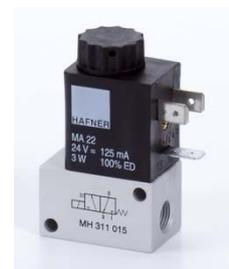
Dieses Ventil kann Drücke bis 10 bar nur bei relativ kleinen Nennweiten steuern. Deshalb sind auch die Durchflüsse relativ gering. Wenn die Nennweite erhöht werden soll, steigt auch die elektrische Leistungsaufnahme analog dazu.
