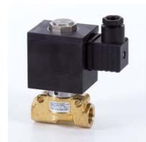
Die elektrische Leistungsaufnahme dieses Ventils beträgt 16W bei 24V DC. Sie ist damit relativ hoch. Die Spule muss daher auf Grund der Hitzeentwicklung relativ groß gewählt werden.
