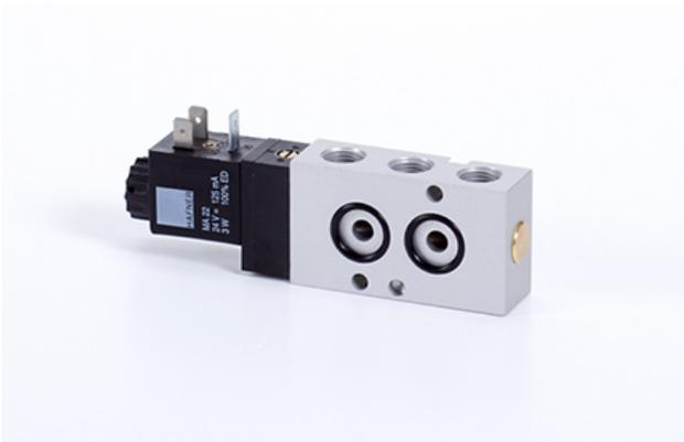
Auf dem linken Bild ist ein elektrisch gesteuertes **5/2-Wege** NAMUR-Ventil abgebildet, Typ MNH 510 701. Dieses dient zur Steuerung eines **doppeltwirkenden Drehantriebs**.
